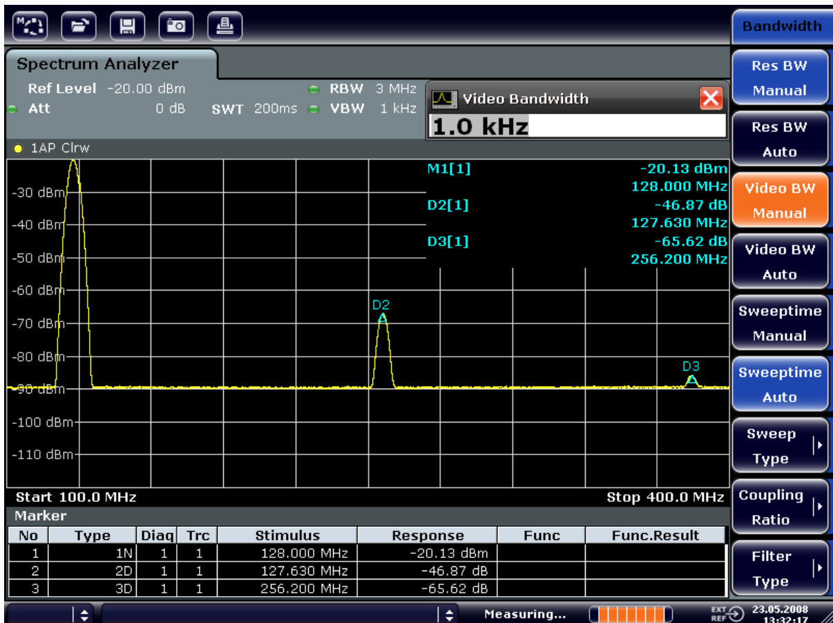
그림 6-11: 하모닉스 측정 시 VBW 을 줄여 잡음 제거하기
